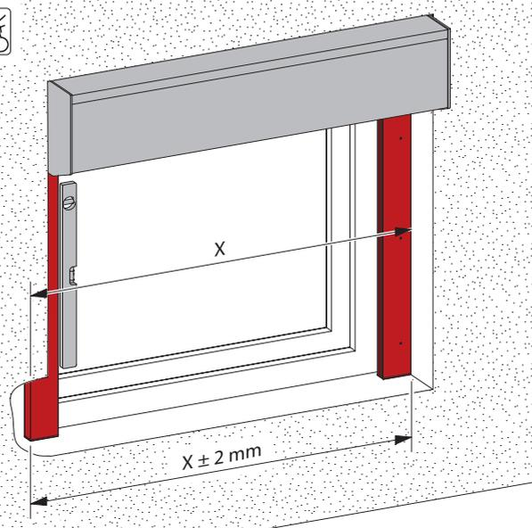
Bei Rollladen-Systemen mit integriertem Fliegenschutz darf die Elementbreite unten an den Führungsschienen nicht mehr als +/- 2 mm abweichen.
