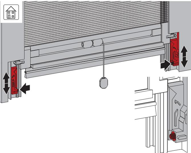
Die Höhe des Insektenschutzgitters kann den baulichen Gegebenheiten angepasst werden.
