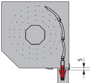
Die obere Endlage muss so eingestellt werden, dass der obere Endanschlag mindestens 5 mm Abstand zum Rollladenkasten hat.
